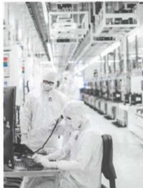
Mikrochip-Produktion bei Globalfoundries: Um die Partikelbelastung im Reinraum so gering wie möglich zu halten, tragen die Mitarbeiter in der Produktion spezielle Reinraumkleidung: einen Reinraumanzug, eine Kopfhülle, Handschuhe, Mundschutz und Schuhe.
